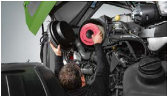
Уровень загрязненности воздушных фильтров отображается на Varioterminal. Доступ к двигателю можно получить очень просто, сняв боковые панели.
