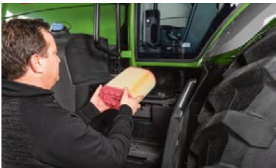
Фильтр кабины находится прямо у дверей, его легко снять и почистить при необходимости.
