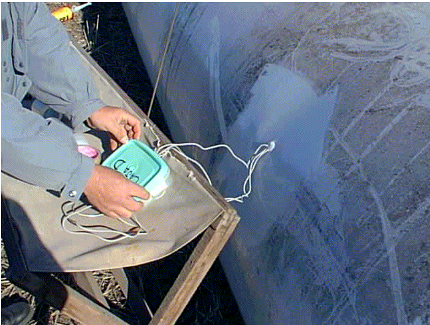
Фото 7. Установка герметичной коробки, содержащей dataloggers, для сбора температурных данных.
