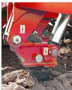
Стойка "Pro-Fit" в качестве гидравлической версии auto-reset доступна на культиваторе "DTX".
