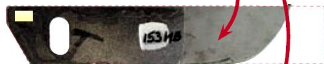
Качественная сталь (S355) после эксперимента
