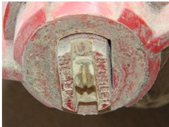
«Закосованный» распылитель – опрыскиватель не промыли после обработки фунгицидом. Фото – А.Кишин, компания DuPont.
