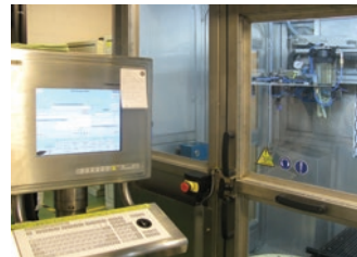
Лабораторное оборудование для моделирования различных условий опрыскивания – скорости, давления, типа распылителей (увь, учесть погодные условия на нем невозможно). Фото Редкозубов И., исследовательский центр DuPont.
