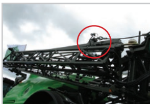
Ультразвуковой датчик высоты на штанге. (Фото Редкозубов И., компания DuPont)
