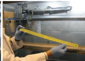
Стенд позволяет обрабатывать растения в горшках, моделируя реальные варианты обработок.
