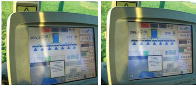
Колебания расхода рабочей жидкости (263,2 – 299,9 л/га) при изменении скорости самоходного опрыскивателя. Фото: Кондратьев А., компания DuPont.
