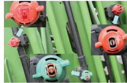
Распылители разных цветов (калибров) и типов на одной штанге. Красный даст расход рабочего раствора на 20% меньше коричневого. Коричневые разных типов – однофакельный и двухфакельный – дадут разное качество на разных культурах и препаратах. Фото А.Килин, компания DuPont.
