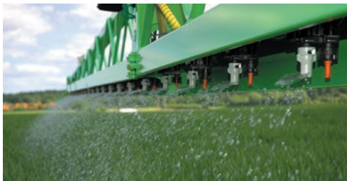
Распылители FD – оптимальное решение для внесения жидких удобрений
