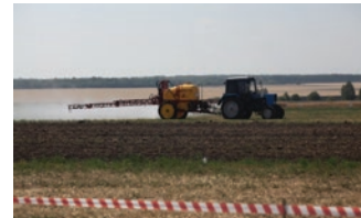
Колебания высоты штанги при движении. (Фото Редкозубов И., компания DuPont)
