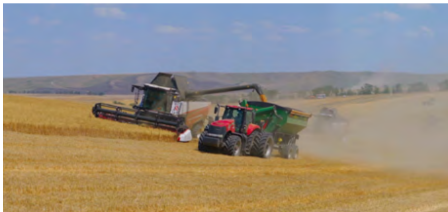
Система точно синхронизирует работу комбайна и бункера-перегрузчика, что позволяет организовать параллельную выгрузку зерна на ходу
