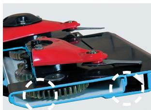
Полностью сварной корпус режущего аппарата с перекрывающим С-профилем для формирования очень прочной и жесткой конструкции.
