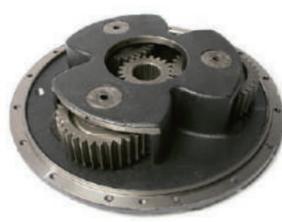
Редукторы с планетарными передачами передают всю возможную мощность через большую прецизионную геликоидальную шестерню. Ступицы планетарного механизма подвешены на подшипниках большого диаметра, прикрепленных прямо к балке моста. Вся нагрузка приходится на балку моста, а не на приводные компоненты.
